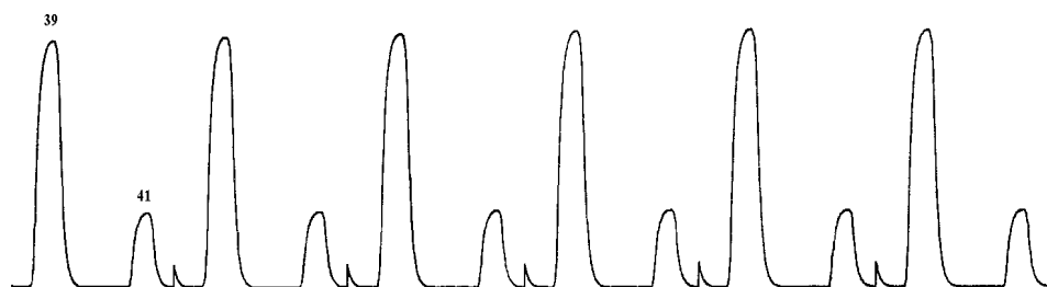
Rys. 3. Przykład serii widm masowych potasu z domieszką izotopu ^{41}\text{K} .
