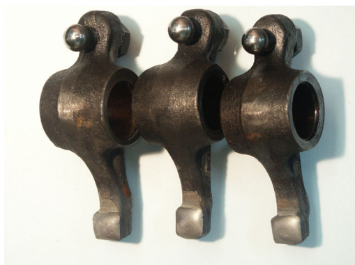
Rys. 3. Dźwignienki zaworowe z powłoką na osnowie niklu (1:2) nieszlifowane
