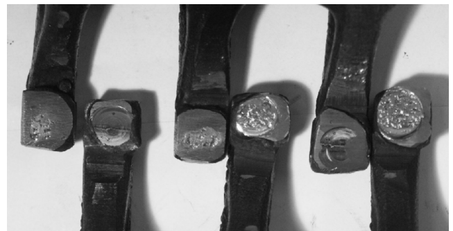
Rys. 1. Widok fragmentów zużytych dźwigienek zaworowych (2:1)
