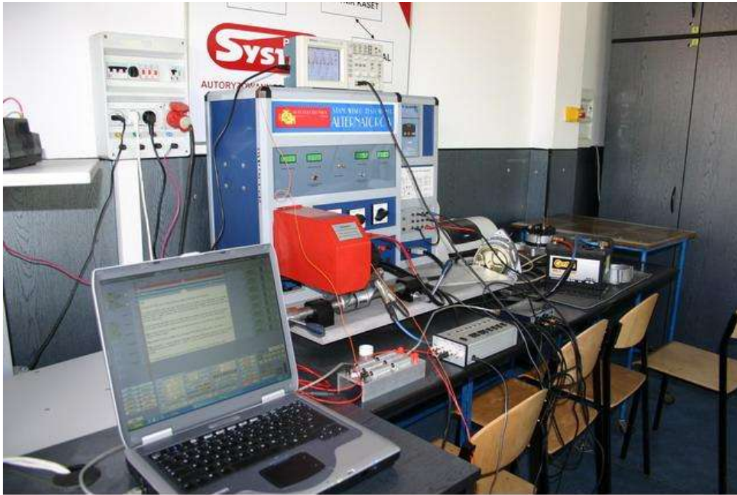
Rys.5. Stanowisko pomiarowe alternatorów.
