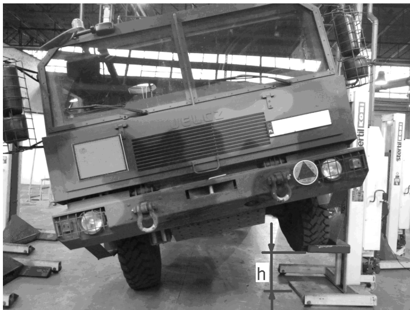
Rys. 8. Pojazd z podniesionym kołem lewym przednim
