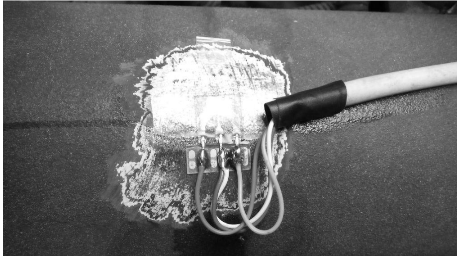
Rys. 7. Tensometr naklejony w punkcie T7
