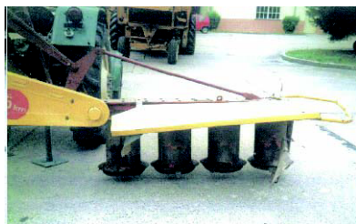
Rys. 1. Kosiarka rotacyjna czterobębnowa RzS-160 Fig. 1. RzS-160 four-barrelled rotary mower
