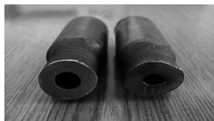
Rys. 5. Fotografie próbek z usuniętą w trakcie procesu owalizacją przekroju poprzecznego ( \alpha=30^\circ , \beta=6^\circ , d_n=20 , d=12 ) (po lewej); próbka z nieusuwalną owalizacją ( \alpha=20^\circ , \beta=8^\circ , d_n=20 , d=12 ) (po prawej)
