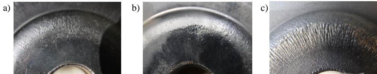
Rys. 2. Widok zużycia wkładek matrycowych po odkuciu: a) 550, b) 1900, c) 4300 odkuciek.
