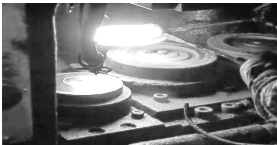
Rys. 1. Wkładki matrycowe- przemysłowy proces kucia na gorąco.
