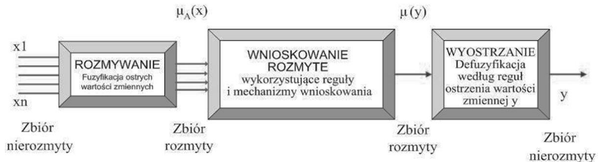
Rys. 2. Model wnioskowania rozmytego
