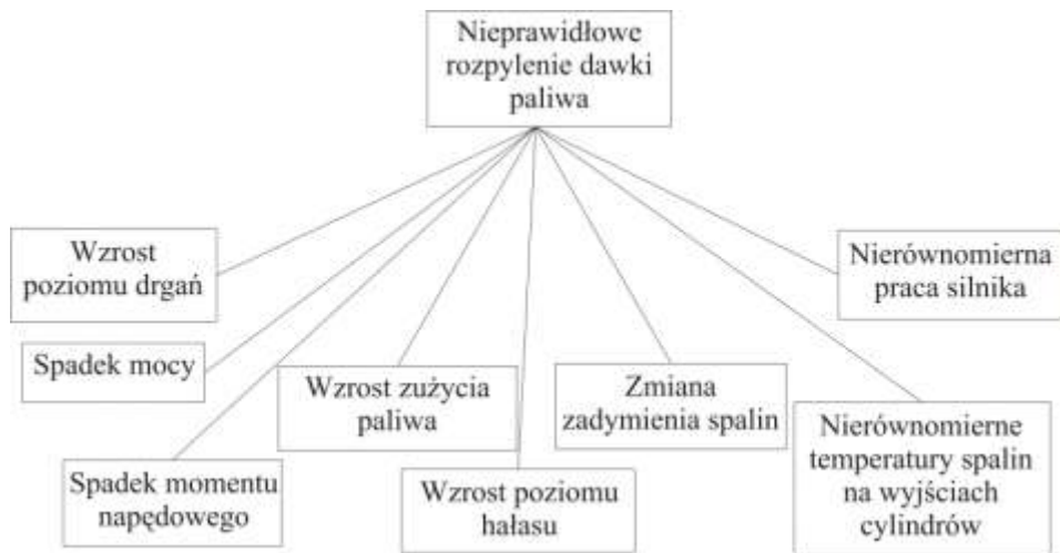
Rys.11. Symptomy diagnostyczne nieprawidłowego rozpylenia dawki paliwa
