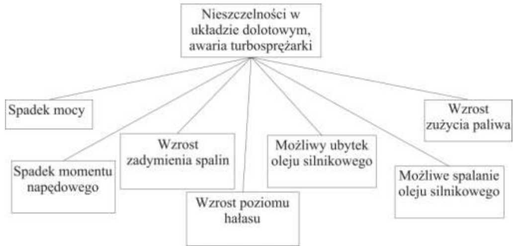
Rys.9. Symptomy diagnostyczne nieszczelności w układzie dolotowym oraz uszkodzenia turbosprężarki
